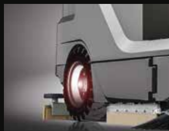
Ruote superelastiche anteriori e posteriori per ridurre al minimo le sollecitazioni aumentando il comfort
