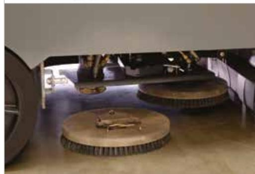
**Spazzola laterale lavante (di serie).** Aumento della pista di lavaggio da 102 a 137 cm con la spazzola laterale che permette una pulizia perfetta anche a filo muro.
