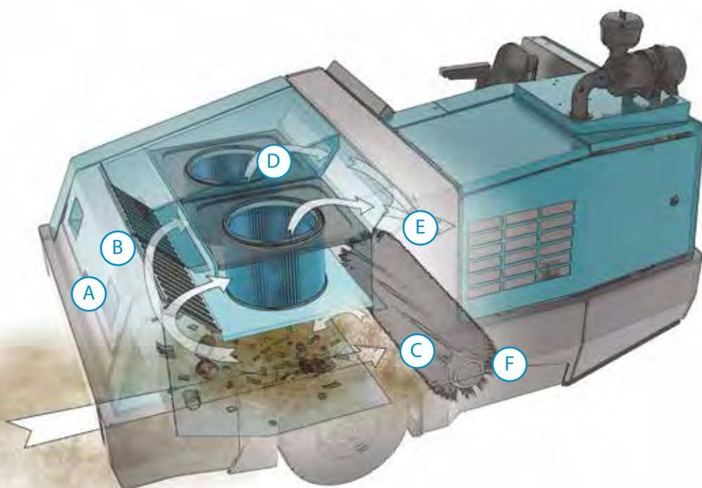
**A** Sensore di temperatura Thermo-Sentry™ per monitorare la tramoggia, che avvia la chiusura dell'aspiratore, in caso di temperature troppo elevate
